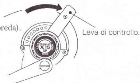
2. Tirate la lenza con la mano in modo da far slittare la bobina e regolare la frizione girando il pomello della frizione verso destra o verso sinistra.
