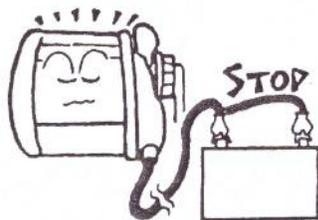
Togliere il cavo di alimentazione appena si termina di pescare o quando il display non mostra il corretto collegamento. Se lasciate il mulinello collegato, si possono provocare danni al motore o incendi.
